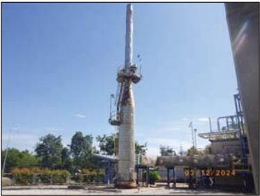
รูปที่ 3.1 Waste Heat Boiler
